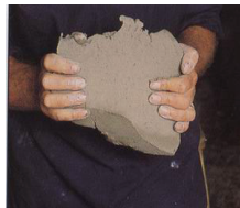
Tanah dipotong tengah menggunakan kawat pemotong
