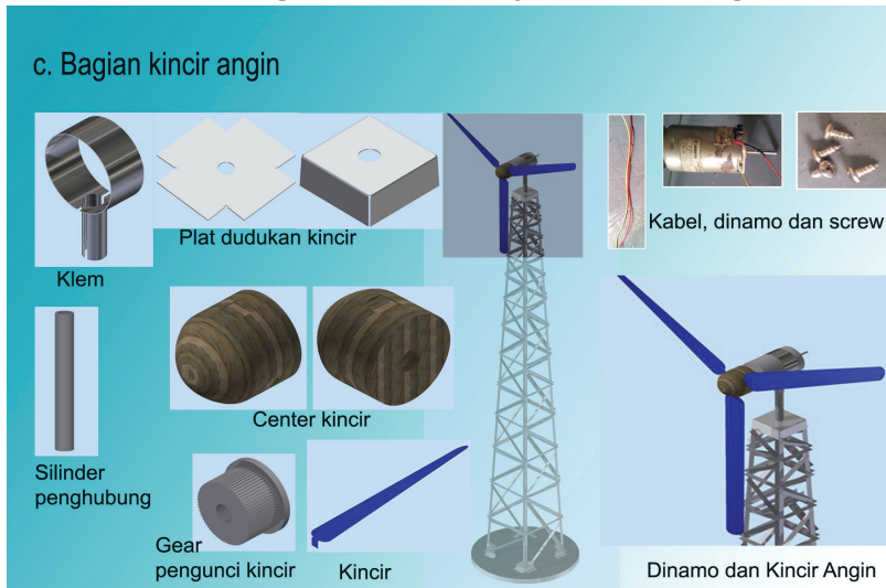
Gambar 2.14 Komponen pembuatan model kincir angin
