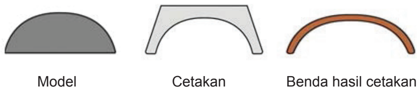
Gambar 1.46 Model, cetakan dan benda hasil cetakan
