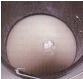
Gambar 1.43 Pencampuran gips dan air
