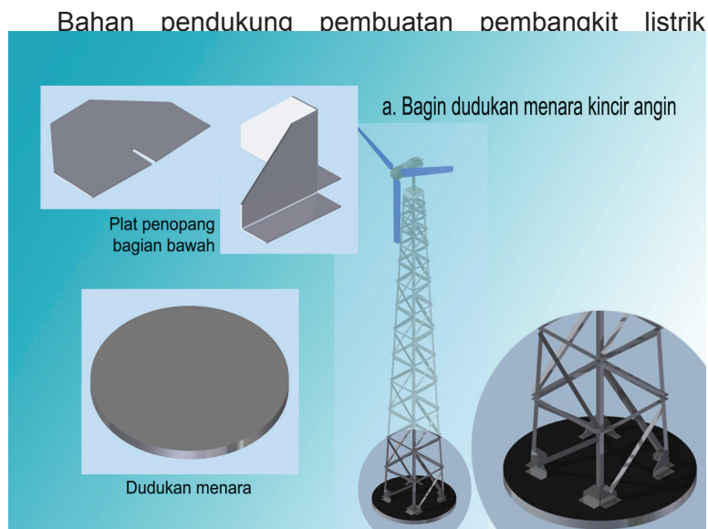
Gambar 2.12 Komponen pembuatan model dudukan menara
