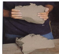
Lakukan proses mengiris dan membanting secara berulang
