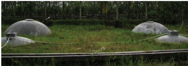
Gambar 2.7 Digester (pengolah) kotoran sapi
