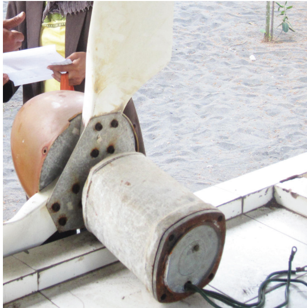
Gambar 2.21 Dinamo pembangkit listrik energi angin
