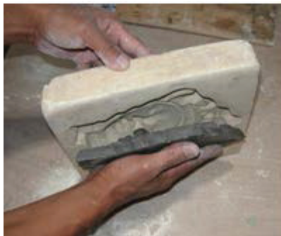
Gambar 1.49 Proses pencetakan model
