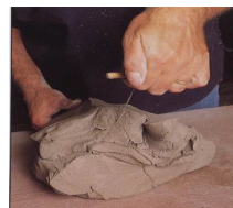
Irislah tanah liat. Bila proses ini berjalan bagus maka bagian irisan tampak merata dan bebas udara
