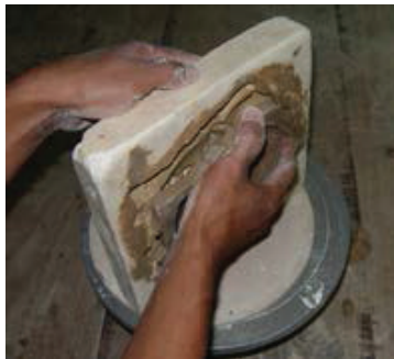
Gambar 1.51 Proses pencetakan teknik cetak tekan
